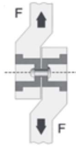
Testing av skjærfasthet
