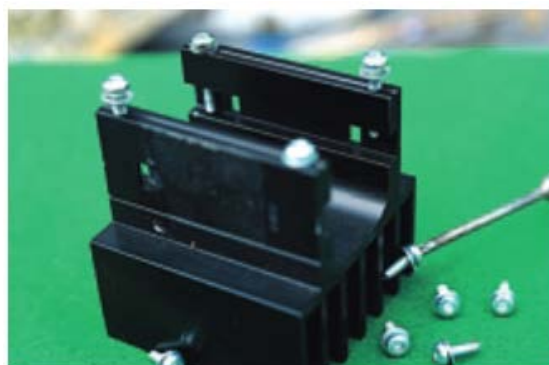
Taptite montert i aluminiumsdelalj.
