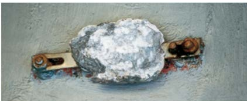
Sink offeranode på stålskrog
